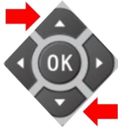
Figura 2 - Tasti funzione per aumentare (sopra) e diminuire (sotto) il volume della chiamata
